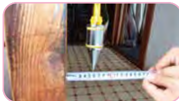
下げ振りで柱の傾きを調査
